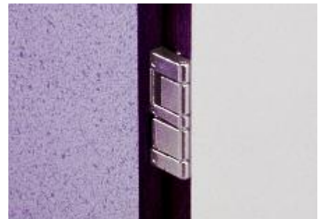
OBJEKTBAND (FA. PRAMETA) FÜR TÜREN AUS COMPACTPLATTEN, TÜRDICKEN 10 - 13 MM. EINACHSDREHPUNKT.
